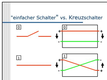
Beim "einfachen" Schalter und überhaupt generell in der Computertechnik bedeutet "0" dass kein Strom oder kein Potential da ist, "1" bedeutet dass Strom bzw. Potential da ist.
