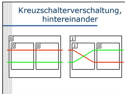
Man kann zwei Kreuzschalter hintereinander schalten und einen Kasten drum herum machen: Das ist wieder ein Kreuzschalter, bei dem die beiden Eingänge entweder parallel oder überkreuz nach draußen geführt werden.
