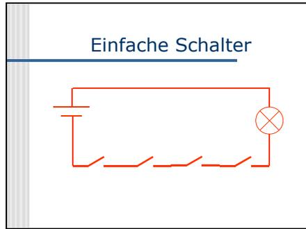
Bei der Hintereinanderschaltung einfacher Schalter brennt nämlich ein Lämpchen genau dann wenn alle Schalter "an" sind.
